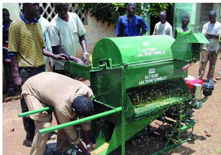
Utilisation d'une batteuse multi-grains pour le battage de riz NERICA à Faranah en Guinée
